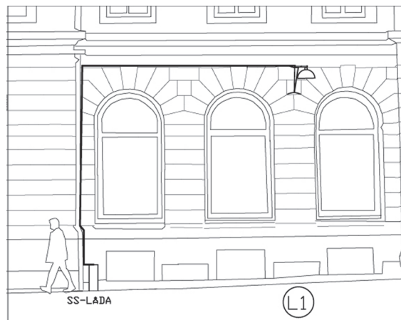
Hur man anlägger kablage för belysning är också viktigt för stadsrummets estetik.
